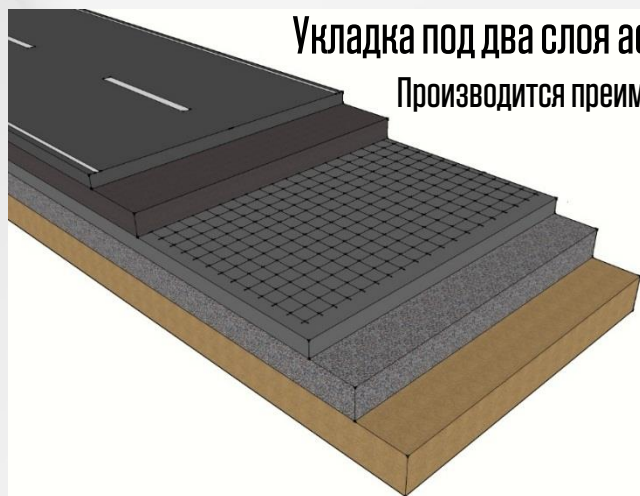
Укладка на цементобетонное основание
