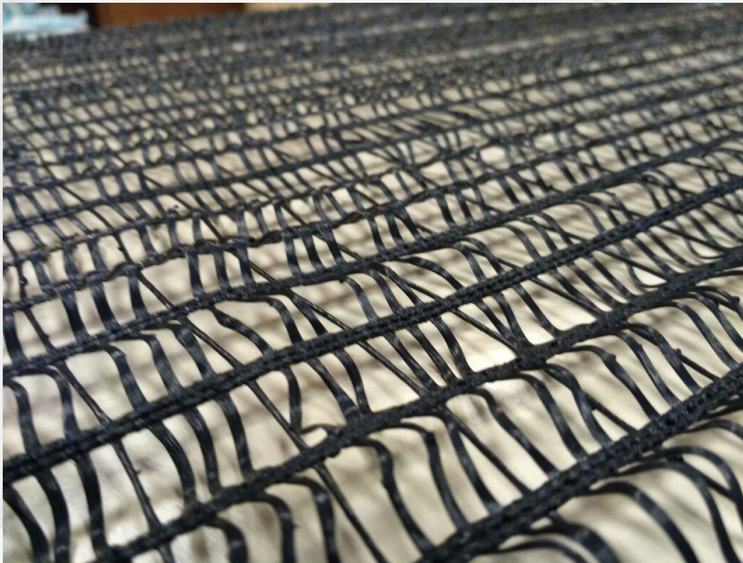
Геомат вязаный пропитанный из полиэфирного волокна и стекловолокна прочностью до 90 кН/м
