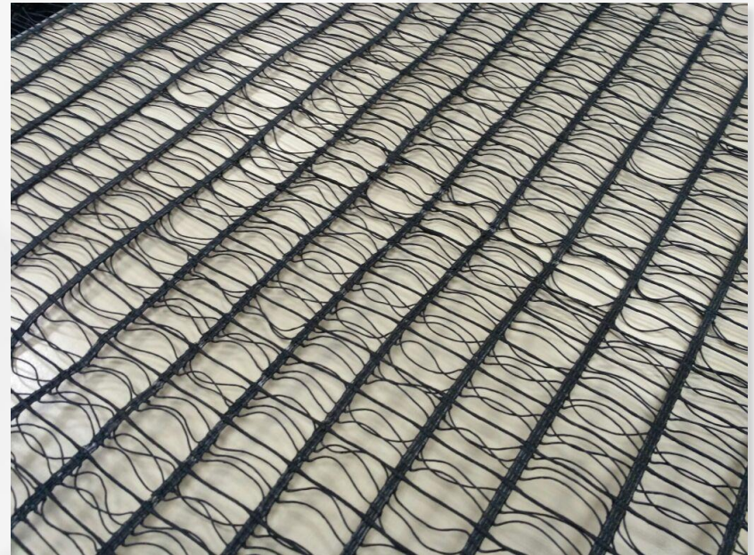
Геомат вязаный пропитанный из полиэфирного волокна прочностью до 90 кН/м
