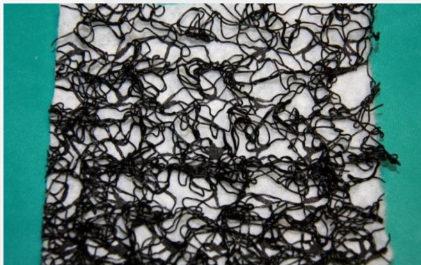
Геомат с подложкой из нетканого полотна (геотекстиля), различной плотности, прикатанного с одной стороны
